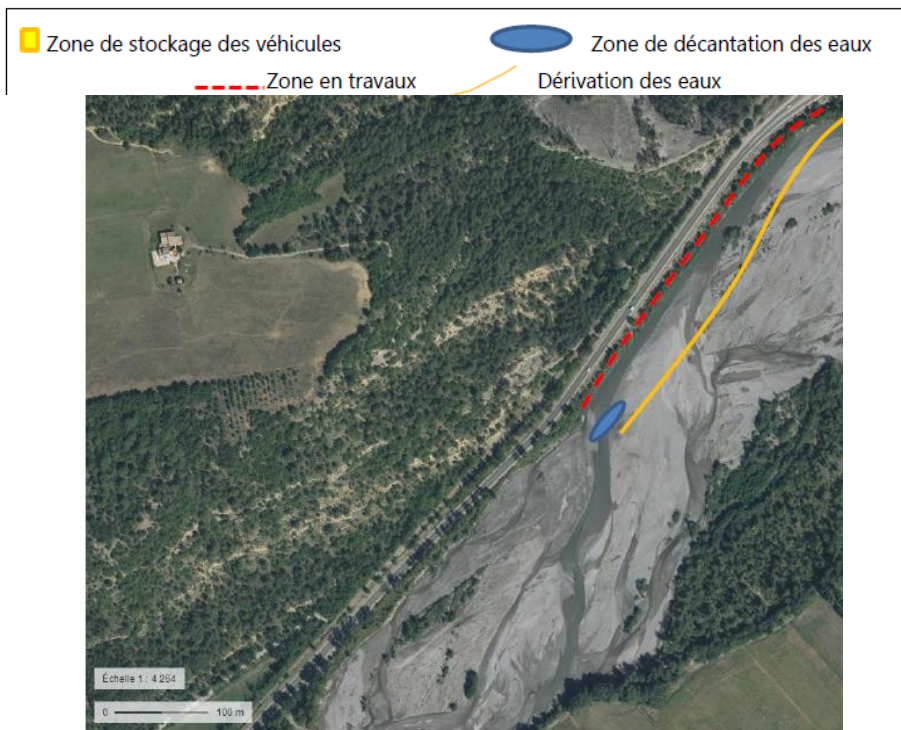
Localisation des installations de chantier – tranche amont (Fond de plan : Géoportail)
